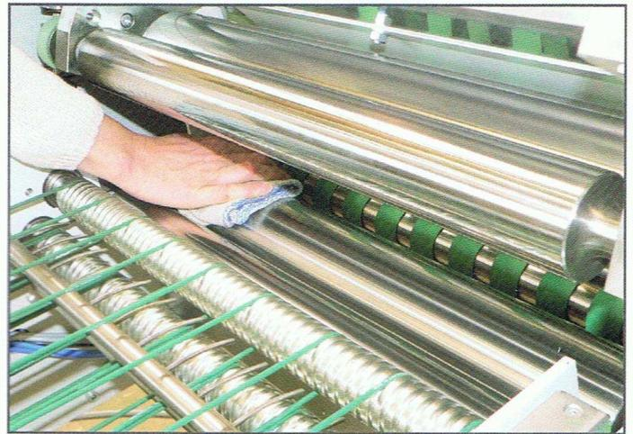
Stazione di pressatura ad apertura pneumatica per consentire una rapida e semplice pulizia dei rulli di pressatura e il prelievo delle segnature doppie
