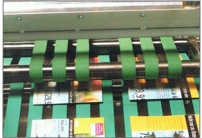
L'alpha consente di eseguire due diversi tipi di trasporto del prodotto nell'alimentazione magazzino: il flusso a squame per le velocità elevate e il trasporto a segnatura singola per un'uscita senza marcature
