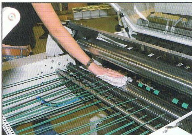
Stazione di pressatura da aprire pneumaticamente per consentire una rapida e semplice pulizia dei rulli di pressatura e il prelievo delle segnature doppie
